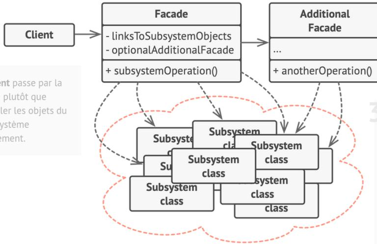
3 Le **Sous-système Complexe** est composé de dizaines d'objets variés. Pour leur donner une réelle utilité, vous devez plonger au cœur des détails de l'implémentation du sous-système, comme initialiser les objets dans le bon ordre et leur fournir les données dans le bon format.
