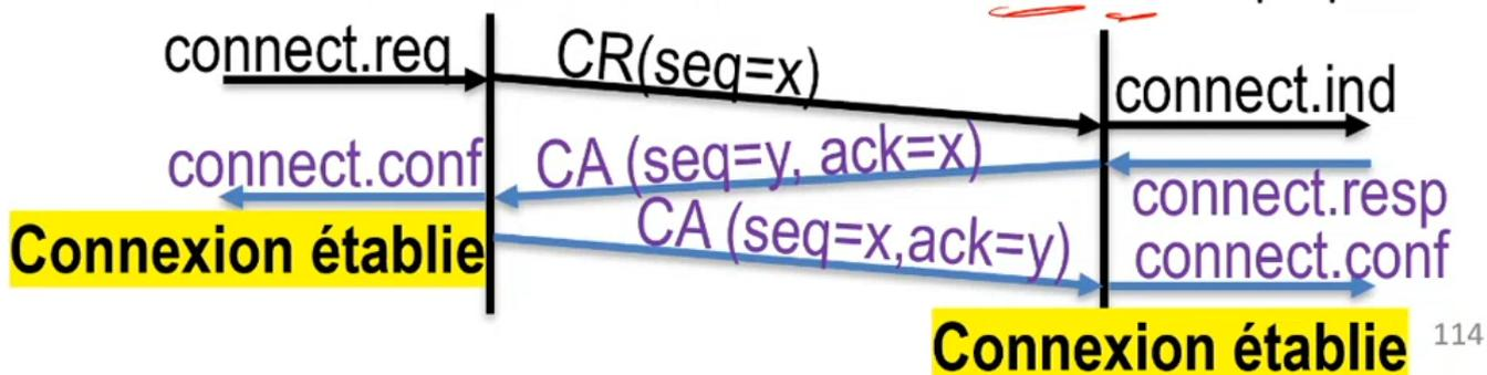
Le client va générer un numéro de séquence (x) et envoyer une demande de connexion au serveur avec ce dernier.
