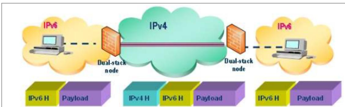
L'idée ici est de créer un tunnel entre le réseau du client et du fournisseur de service IPv6 (par exemple un site internet). Cela consiste à mettre des paquets IPv6 dans des paquets IPv4.
