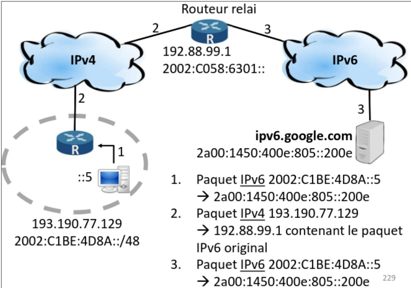
Une autre idée est d'utiliser des "tunnels automatiques" tel que des routeurs 6to4 qui vont faire le pont entre l'Internet IPv6 et l'Internet IPv4.
