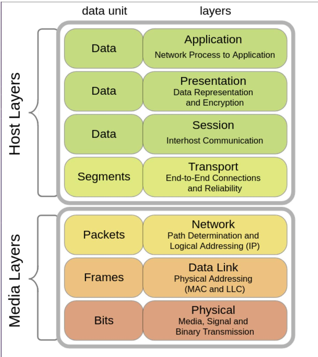
Le modèle OSI est une norme de communication réseau proposée par ISO. Elle met ainsi en relation plusieurs protocoles de communications différents (IP, HDLC, TCP, UDP, HTTP, etc).
