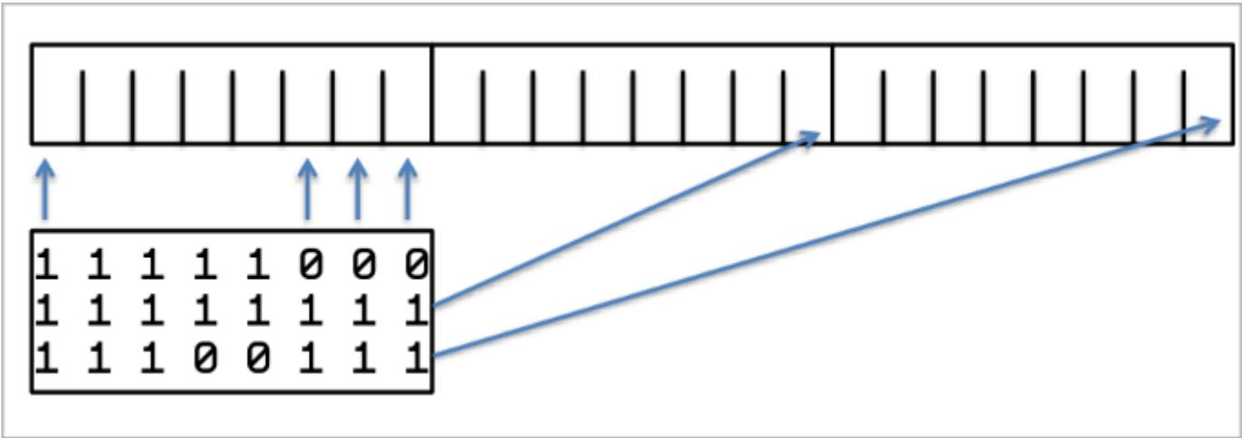
La table de bits correspond à une cartographie de la mémoire découpée en blocs d'allocations de taille fixe. Pour chaque bloc, on va noter un 1 si c'est occupé, ou un 0 si le bloc est libre dans la table de bits.
