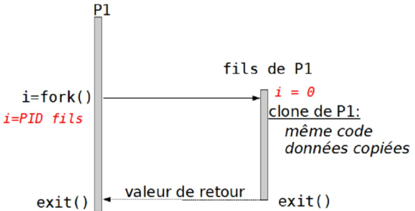
Pour créer un processus on utilise l'appel système *fork*. Le processus créé par un *fork* est appelé le processus *fils*, et le processus qui a créé le *fils* est appelé le *père*.
