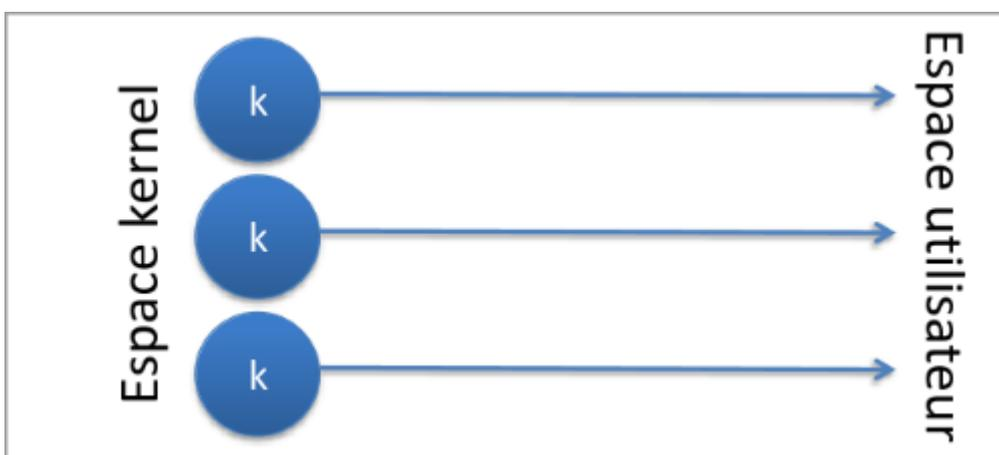
Dans ce modèle chaque thread utilisateur est attaché à un thread kernel. Ainsi les threads sont complètement gérés au niveau du système d'exploitation.
