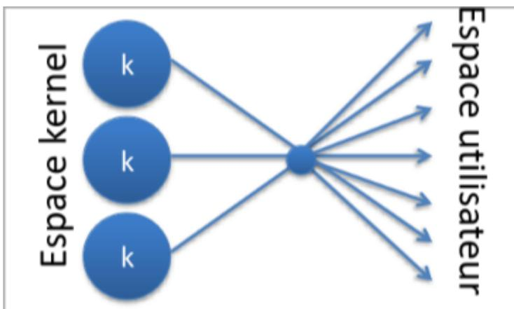
L'idée du plusieurs à plusieurs est de créer un *pool* de thread au quel les threads utilisateurs vont être assignés à la volée au cours de l'exécution.
