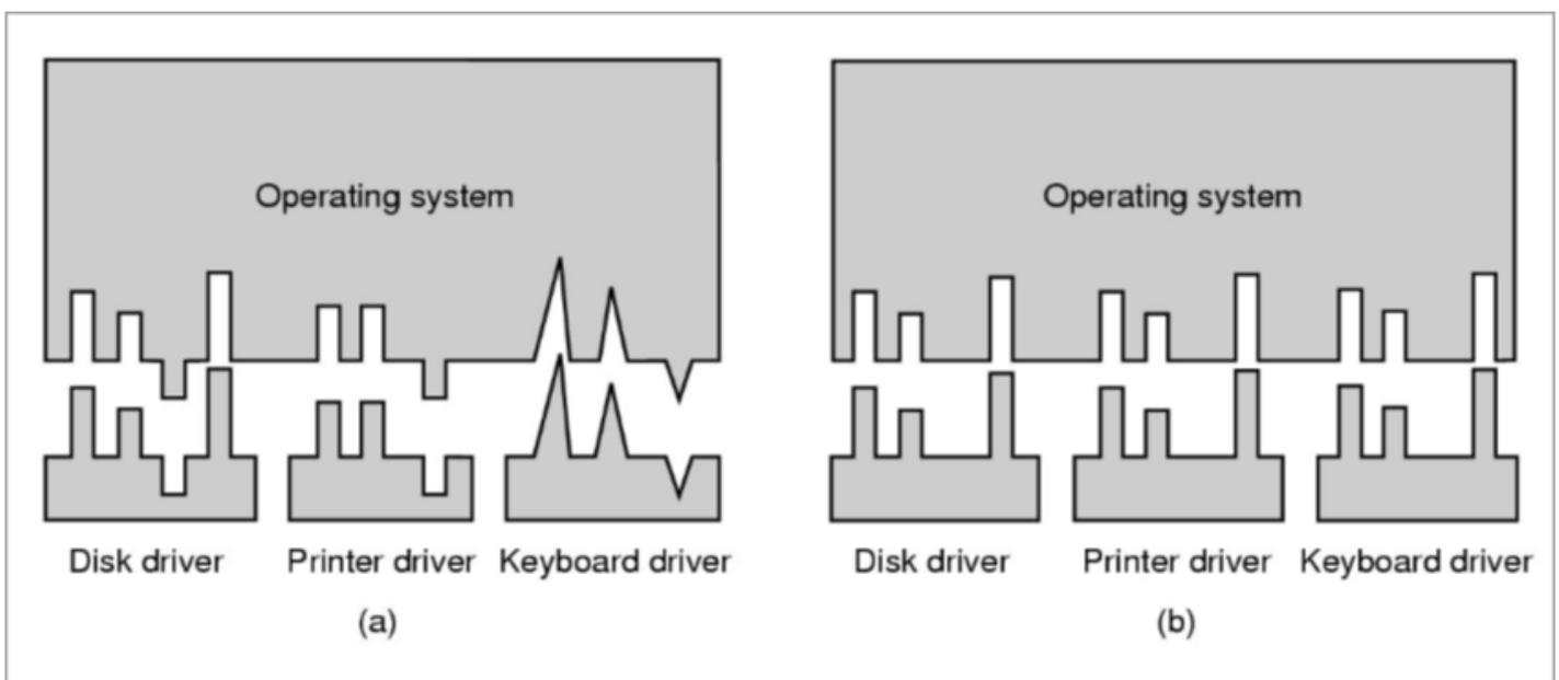
*A gauche, un système sans interface standard, à droite un système avec une interface standard*
